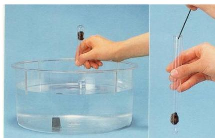
もっともよくさびるのは水と空気の境目です。鉄がさびるときに酸素と結びつくことを確かめたのが左の実験です。試験管の中にあつた空気にふくまれる酸素が減つたため、試験管の中に水が上がってきています。その右では線香の火が消えています。また、鉄の赤さびは鉄の中を腐食していくため、鉄はその性質が失われてもろくなっていきます。
