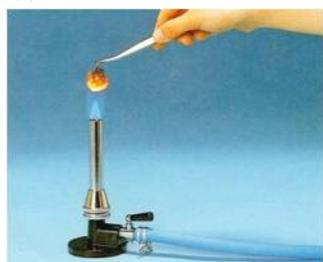
鉄はそのままでは燃えにくいものですが、スチールウールにして、ガスバーナーの炎に近づけると、パチパチと赤い火花を出して燃えます。そして、燃えたあとは(27…酸化?)に変化しています。その重さも約1.4倍に増えています。
