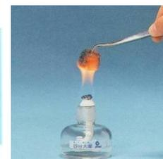
**重要**…鉄の黒錆は電気を通して磁石にもつきますが、赤錆は電気を通さず、磁石にもつきません。
