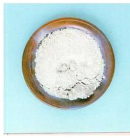
マグネシウムの粉を皿にのせて熱すると、明るく白っぽい光を出してはげしく燃えます。そして、燃えたあとは(24…酸化?)という別な性質の白い粉に変化しています。さらに、その重さも約1.7倍に増えています。このときに増えた0.7がマグネシウムと結びついた(25)の重さです。
