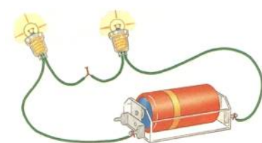
(図1) 豆電球の 直列つなぎ と回路図
